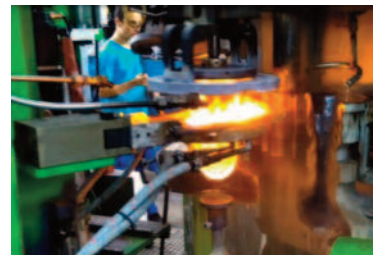
Şekil 9. Parizon şartlandırma istasyonu
