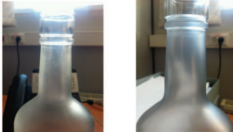
Resim 3. Kestamid malzeme ile yapılan kaplama(solda), yeni tip tutucu ile yapılan kaplama(sağda, boyunda kaplama hatası kalmamıştır)
