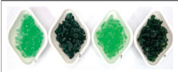
Şekil 2. Üretilen camlar. Mavimsi yeşil camlar; 1: % 0,1 bakır içerikli, 2: % 2,5 bakır içerikli. Sarımsı yeşil camlar; 3: % 0,1 demir içerikli, 4: % 2,5 demir içerikli.
