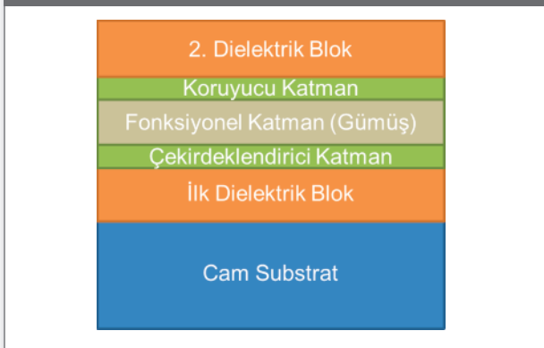
Şekil 2. Tek gümüşlü low-e kaplamalı camın şematik katman dizilimi
